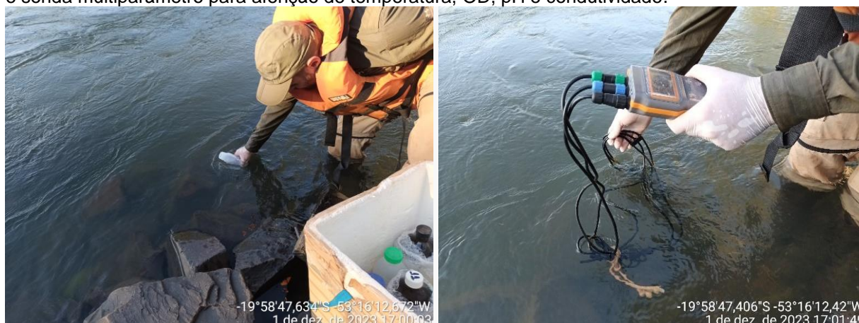
Figura 4 - Procedimentos de amostragem utilizando frasco de polietileno para análises físico-químicas e sonda multiparâmetro para aferição de temperatura, OD, pH e condutividade.
